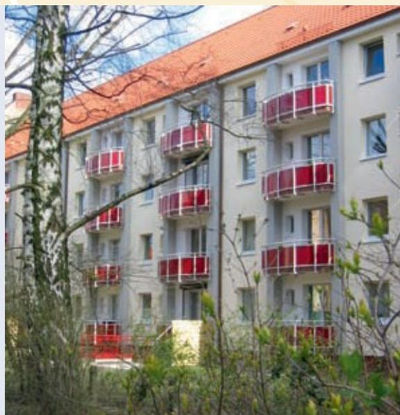
Bei den Einzelmaßnahmen im Modernisierungsplan 2008 handelt es sich hauptsächlich um Wärmedämmmaßnahmen an Fassaden, Dach und Kellerdecken im Eydtkuhnweg 4 a-d. Nach Durchführung aller Arbeiten wird auch hier der Niedrigenergiehausstandard erreicht. Neue Fenster mit Wärmeschutzverglasung werden im Wildacker 2-24 eingebaut. Die Häuser im Wildacker 46-52 erhalten neue Eingangselemente mit Gegensprechanlagen.
